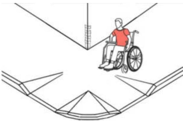
Бордюрный пандус отличается от пандуса: бордюрный пандус расположен на тротуаре (элемент тротуара), и наклонная поверхность является частью тротуара, его нижняя горизонтальная площадка расположена на проезжей части. Поручни, как правило, отсутствуют
