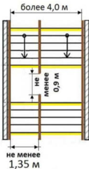
При расчетной ширине проходной части внешней лестницы 4 м и более следует предусматривать центральные двусторонние поручни.
