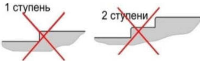
Следует исключать размещение одиночных ступеней (одна или две)
