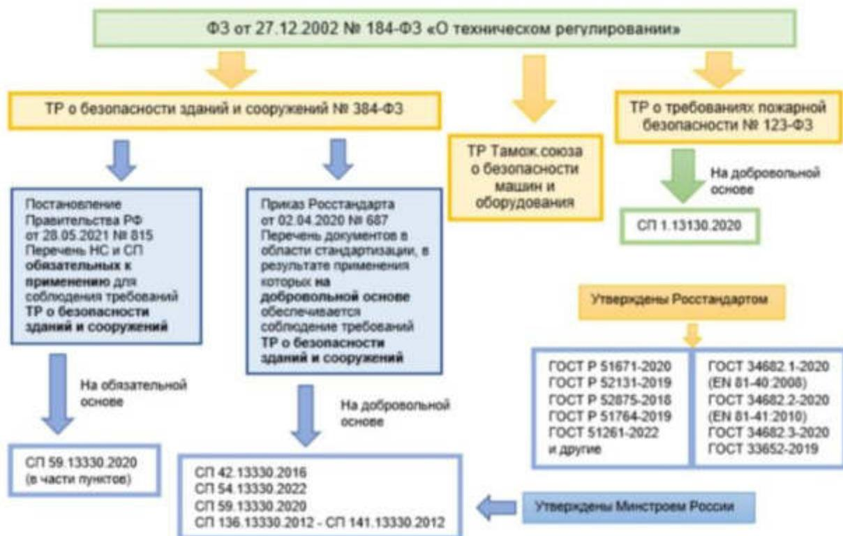
Рис. 1.2. Система нормативно-технических требований в сфере доступной среды
